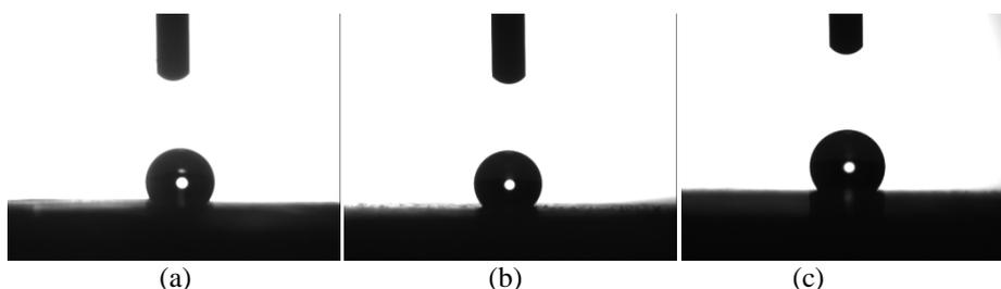
**Fig. 3:** Water droplet on electrospun PVDF a) 11 wt.% b) 13 wt.% c) 15 wt.%
